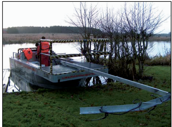
Figur 2. Elfiskebåden med dens udskydelige bom i stævnen. Fra bommen hænger fem anoder (wirer) ned i vandet.
