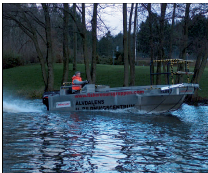
Figur 17. Elfiskebåden ved Kongensbro. Man ser i stævnen den udskydelige bom, hvorfra de positive elektroder hænger ned i vandet. Fra platformen i stævnen samles fiskene op med ketchere.
